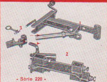
Montage de la douille porte-outils (2) sur le porte-outils du brabant « Série 220 » (1) par simple cheville (3).
