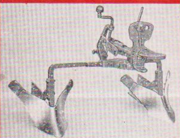
Buttoir double réglable N° 55 Pour le buttage des cultures en ligne (pommes de terre, haricots, etc.). Porte-outils nécessaire.
