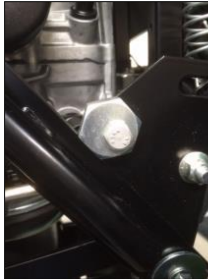
Position 1 « medium » Hauteur = 44mm
