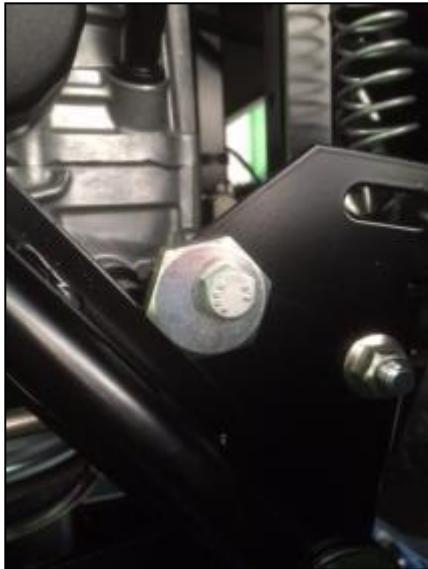
Position 1 « haute » Hauteur = 48 mm
