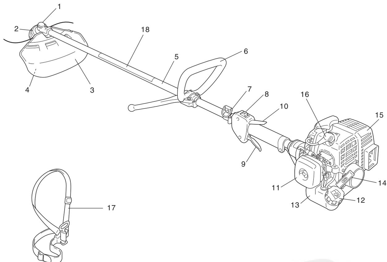
1. **Renvoi d'angle.** Avec deux engrenages pour changer l'angle de l'axe de rotation.
