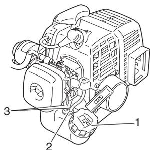
1. Bouchon du réservoir de carburant      3. Tuyau de carburant
