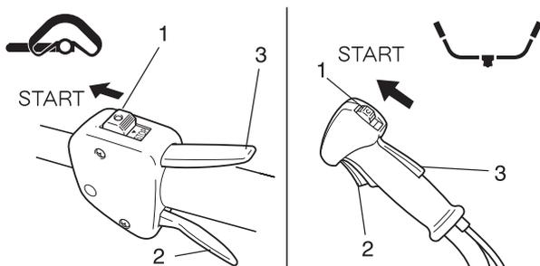
1. Placer l'interrupteur marche/arrêt en position Marche.
