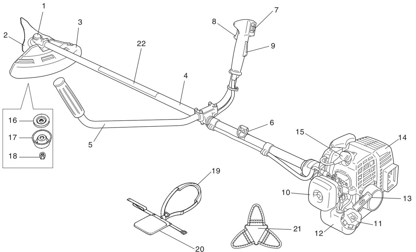
1. **Renvoi d'angle.** Avec deux engrenages pour changer l'angle de l'axe de rotation.
