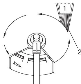
La tête de coupe à fil nylon tourne dans le sens inverse des aiguilles d'une montre. Le couteau se situe sur le côté gauche du protecteur d'outil.
