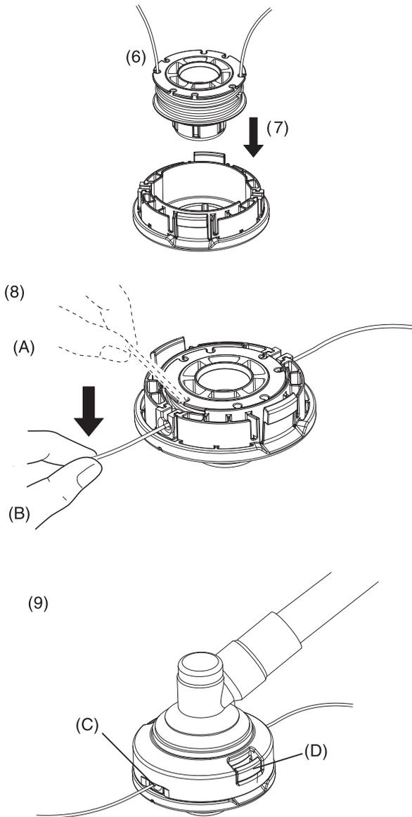
6. Lorsque le fil est entièrement enroulé autour de la bobine, accrocher ses deux extrémités dans les encoches correspondantes de la bobine pour le bloquer provisoirement ; laisser environ 10 cm de fil dépasser des encoches.
