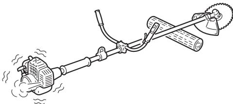
1. Lorsque le moteur démarre, le laisser chauffer au ralenti (c.-à-d. à bas régime) pendant 2 à 3 minutes.
