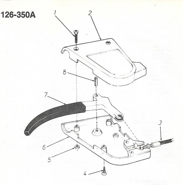
PARTS LIST FOR CONTROL LEVER ASSEMBLY BREAKDOWN 126-350A
